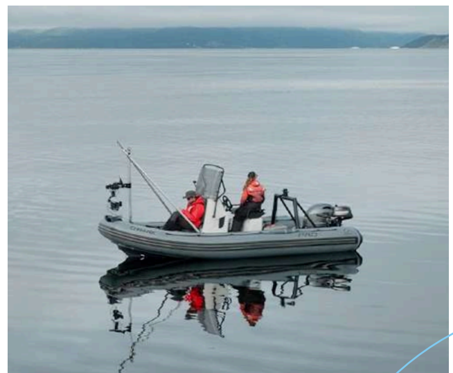
À quoi sert cette intrigante structure de métal à l'avant du bateau? À fixer des caméras!
